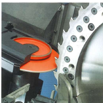
Retificadoras de dentes com largura de lâmina de até 14 mm.
