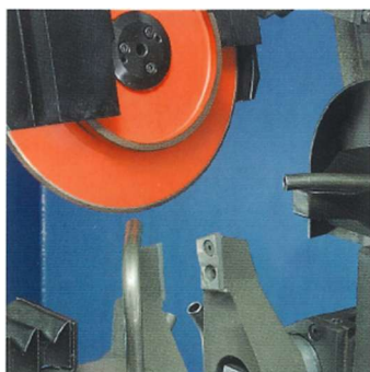
O grampo rígido da lâmina pode ser aberto extremamente, permitindo fácil acesso para a troca da lâmina de serra.
